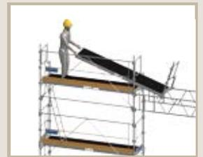
Mise en place des planchers en sécurité grâce au chariot à faire rouler le long des traverses des poutres aluminium.
