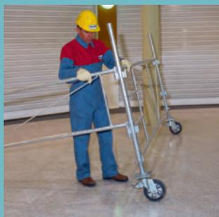
Les cadres de liaison se fixent aisément aux cadres porteurs par verrou automatique.
