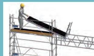
Mise en place des planchers en sécurité grâce au chariot à faire rouler le long des traverses des poutres aluminium.
